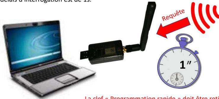
La clef « Programmation rapide » doit être retirée après paramétrage afin d'économiser les piles.
