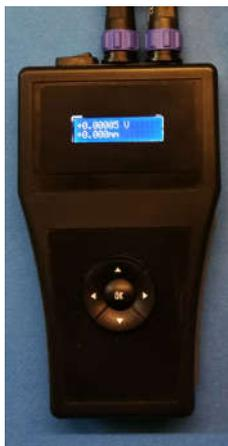
Test LVDT AC, permet le réglage sur site
