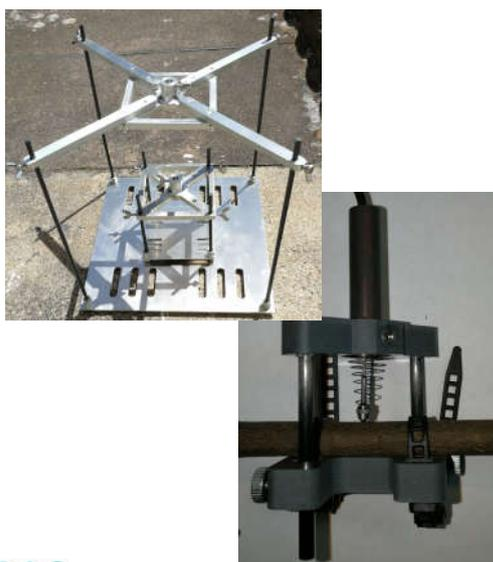
Les montures sont équipées d'entretoises en carbone, cette matière à un coefficient de dilatation thermique pratiquement nul et une grande rigidité, tout en étant légère. C'est tout de même une matière fragile. **Tous les serrages doit être réalisés à la mains sans être excessifs. Ne pas utiliser de pince.**
