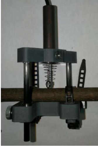
Monture pour petits végétaux jusqu'à 35 mm Ex. d'utilisation : Lavande (Lamacque et al. 2020 – Plant Physiology).
