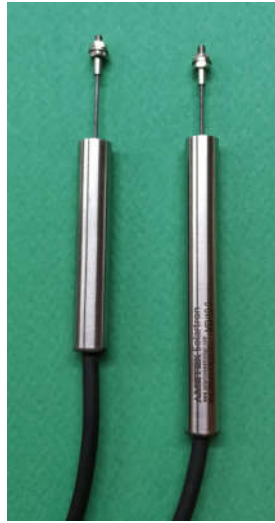
LVDT de type AC Solartron MD5
