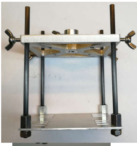
Monture pour petites branches jusqu'à 100 mm
