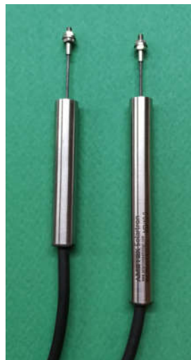
LVDT de type AC Solartron MD5
