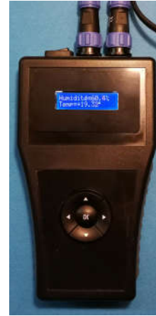
Mesure manuelle de l'hygrométrie et de la T°C
