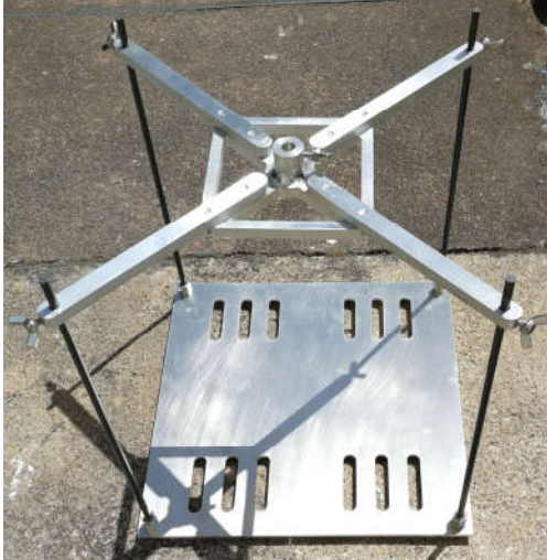
Monture pour grosses branches jusqu'à 250 mm
