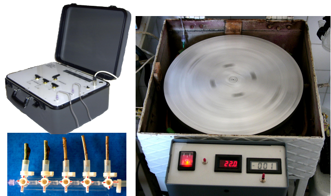
Fig 3: Outils de mesure de l'embolie : XYL'EM (à gauche) et CAVITRON
