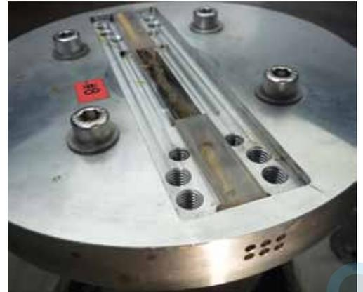
Le Cavitron : un prototype d'instrument de mesure capable de caractériser la tolérance à la sécheresse des arbres *via* la mesure de la conductance hydraulique d'un rameau sous pression négative.
