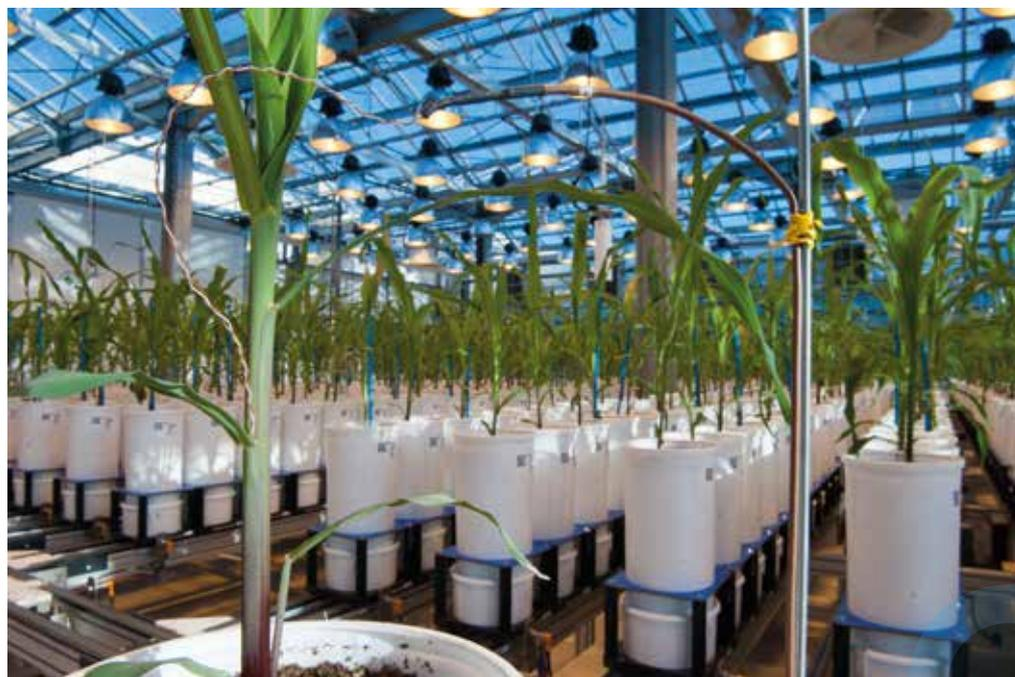
Sonde thermique (thermocouple) mesurant la température des organes d'une plante témoin de la plateforme PhenoArch.
